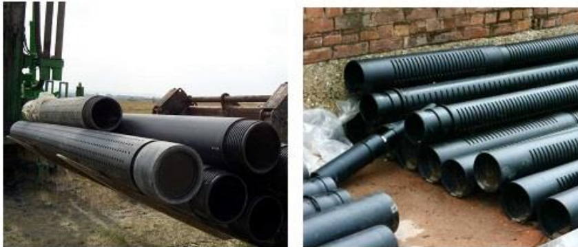
Rys. 43 Typowe filtry studni gazowych – perforacja otworowa (z lewej) i szczelinowa (z prawej)
