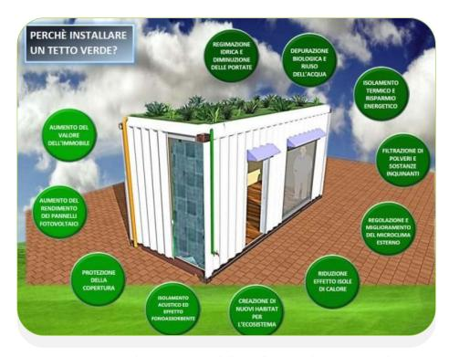
Figura 2.1 - Alcuni vantaggi dell'installazione di un tetto verde
