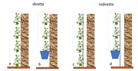
**Figura 3.4** - Tipologie di facciate verdi. *a)* Facciata verde diretta con piante in piena terra; *b)* Facciata verde diretta con piante in vaso; *c)* Facciata verde indiretta con piante in piena terra; *d)* Facciata verde indiretta con piante in vaso
