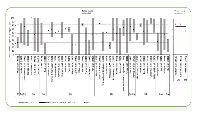
**Figura 2.11 -** Percentuale di ritenzione idrica degli eventi meteorici in funzione delle fasce climatiche secondo il sistema di classificazione climatico di Köppen-Geiger Fonte: Manso et al. Green roof and green wall benefits and costs: A review of the quantitative evidence. 2020
