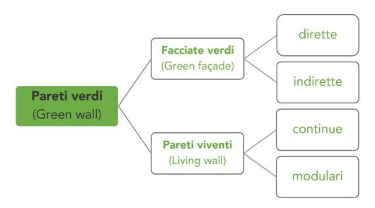
**Figura 3.3 -** Classificazione delle pareti verdi in base alla loro tipologia costruttiva (Fonte: l'immagine è stata rielaborata a partire da Manso & Castro-Gomes, 2015<sup>11</sup>)
