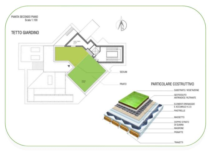
Figura 5.17 - Dettagli del "tetto giardino" e della tipologia di substrato
