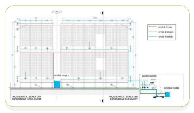
**Figura 5.15** - Layout del sistema di fertirrigazione installato sulla parete verde (Report RdS/PAR2015/141<sup>42</sup>)
