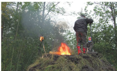
Kyösti ja Elmeri Heikkilä hiilimiilun päällä valmistamassa, että keskellä olevassa reiässä sytykkeet palavat ennen aukon peittämistä.
